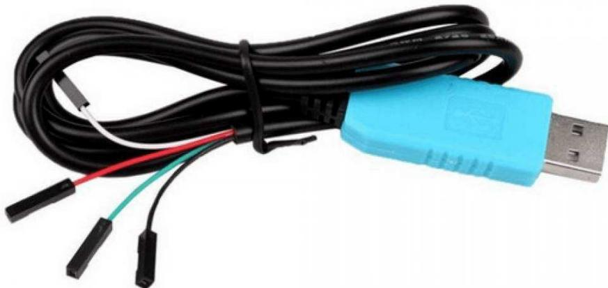
Dans le premier cas, il faudra utiliser des câbles Dupont pour relier les masses de l'un et de l'autre, le RX du RPi sur le TX de l'adaptateur, et le TX du RPi sur le RX de l'adaptateur.
