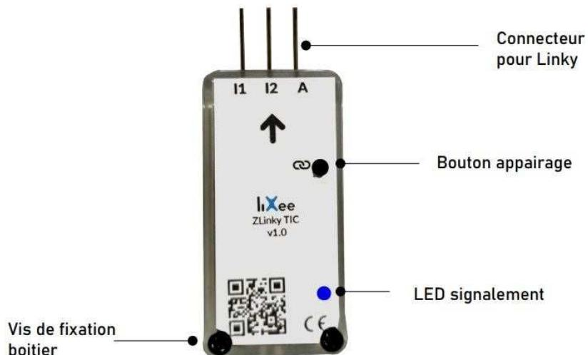
Une fois le module inséré par l'électricien et l'antenne fixée, vérifier que le serveur Zigbee2MQTT est bien actif, avec l'appairage autorisé.
